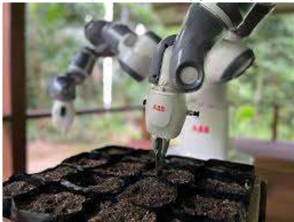
Gambar. 17 Sistem Robot Untuk Penanaman benih
