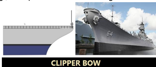
Gambar 6. Haluan kapal clipper bow Sumber : Ilmu Kapal dan Logistik, 2023
