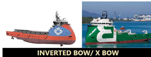
Gambar 11. Haluan kapal inverted bow Sumber : Ilmu Kapal dan Logistik, 2023
