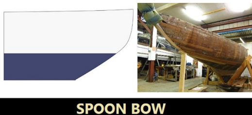
Gambar 7. Haluan kapal spoon bow Sumber : Ilmu Kapal dan Logistik, 2023
