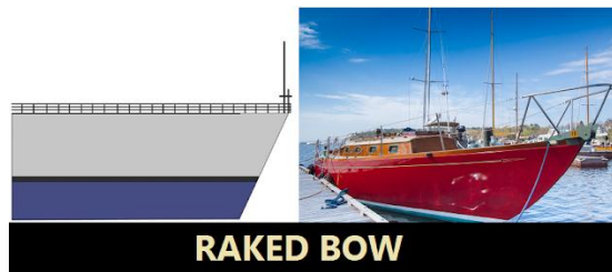
Gambar 5. Haluan kapal raked bow Sumber : Ilmu Kapal dan Logistik, 2023
