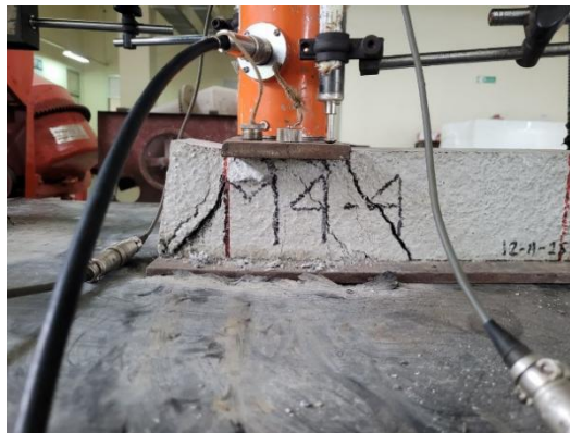
Gambar 11. Visualisasi Pola Retak Benda Uji Akibat Beban Tekan
