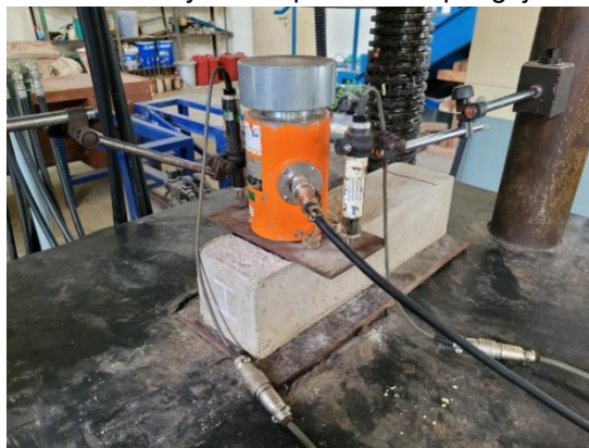
Gambar 8. Pengujian Kuat Tekan
