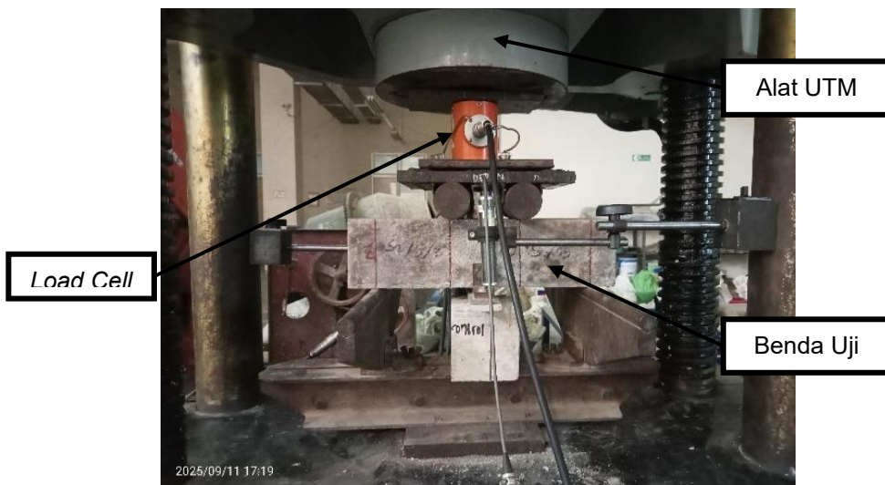
Gambar 7. Pengujian kuat lentur beton
