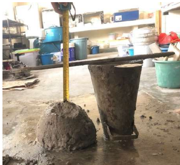
Gambar 9. Pengujian Slump Test
