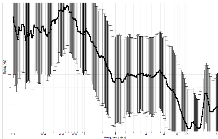
Gambar 10. Kurva eliptisitas Rayleigh yang siap untuk diinvertasikan dalam Dinver.
