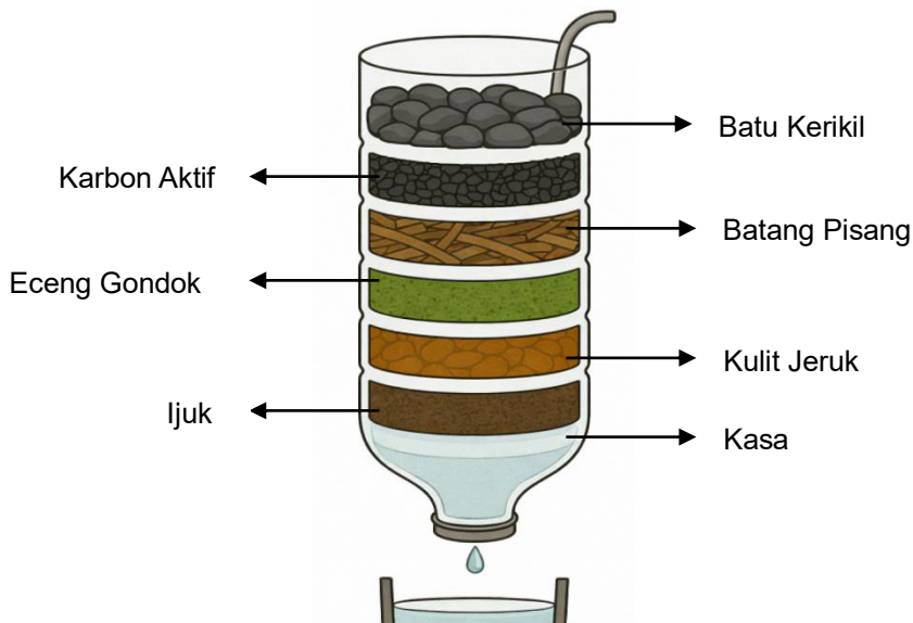
Gambar 2. Susunan media filtrasi multilapis berbasis biomassa pertanian
