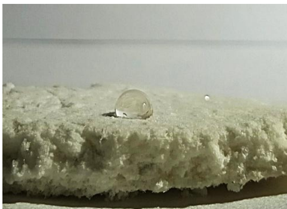
Gambar 2.6 Aerogel termodifikasi PDMS
