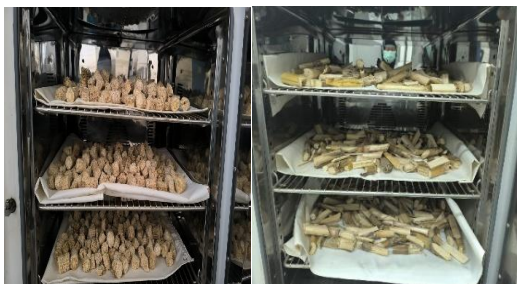
Sampel yang telah dikeringkan dalam oven selama 16 jam
