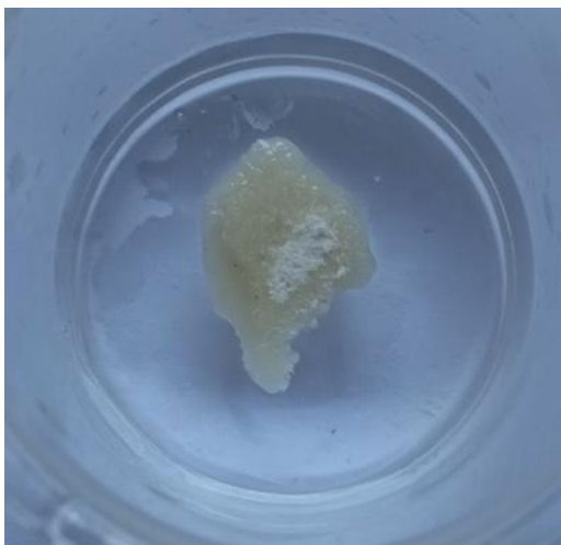
Gambar 3.2. Proses adsorpsi antara minyak dengan adsorben aerogel selulosa
