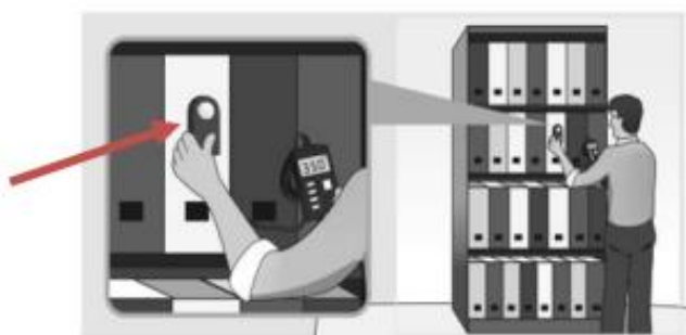
Gambar 2 2 Pengukuran pada bidang vertical
