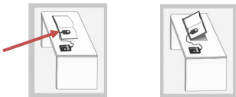
Gambar 2 1 Sensor sejajar dengan permukaan objek
