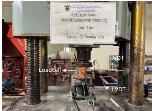
Gambar 5. Pengujian Kuat Tekan
