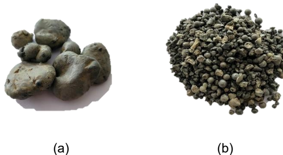
Gambar 1. Slag nikel (a) Sebelum crushing (b) Sesudah crushing )
