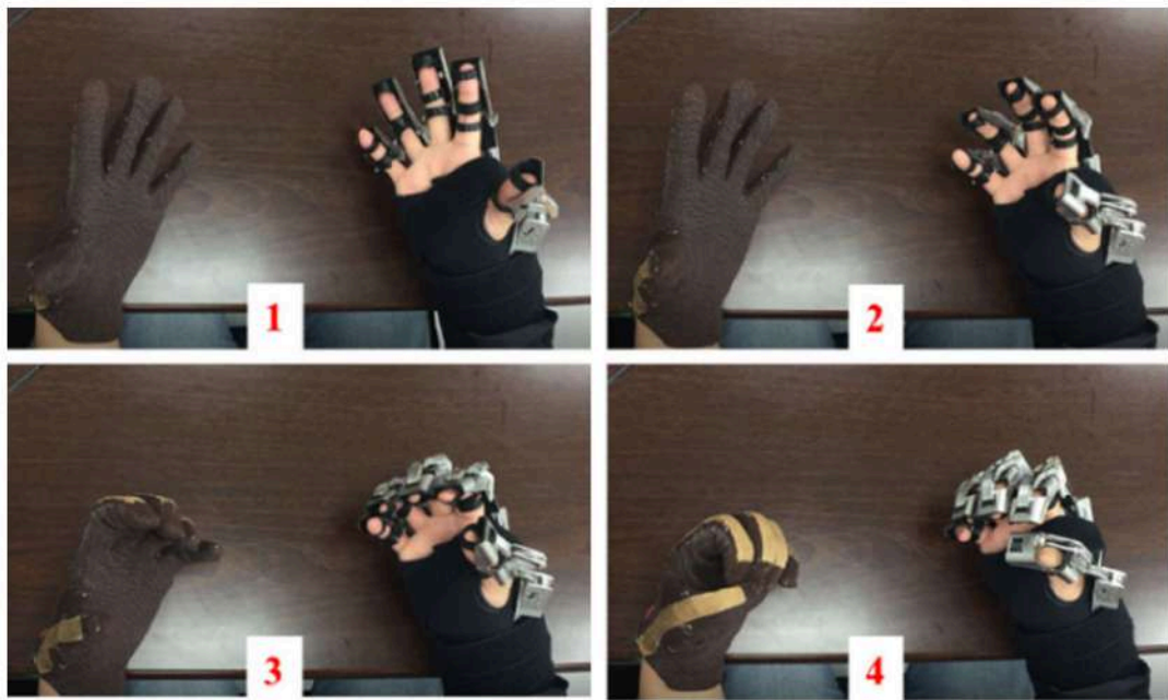
Gambar 4. Imitasi Gerakan Pada Hand Exoskeletal Robotic Mirror Therapy (Schrader, 2022).
