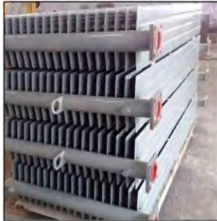
Gambar 9. Radiator (Sumber: PLN, 2024)
