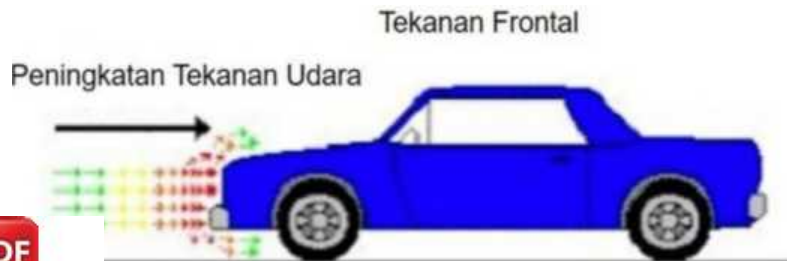
Gambar 5 Tekanan Frontal Pada Mobil (Azizi, 2010)
