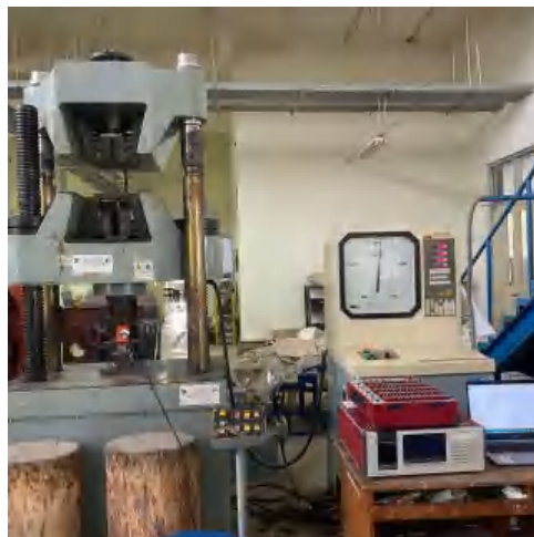
Gambar 4 Pengujian Kuat Tekan
