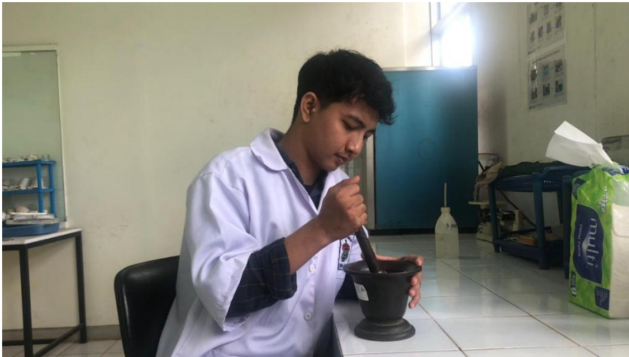
Gambar 3. Tahapan reduksi ukuran sampel menggunakan mortar
