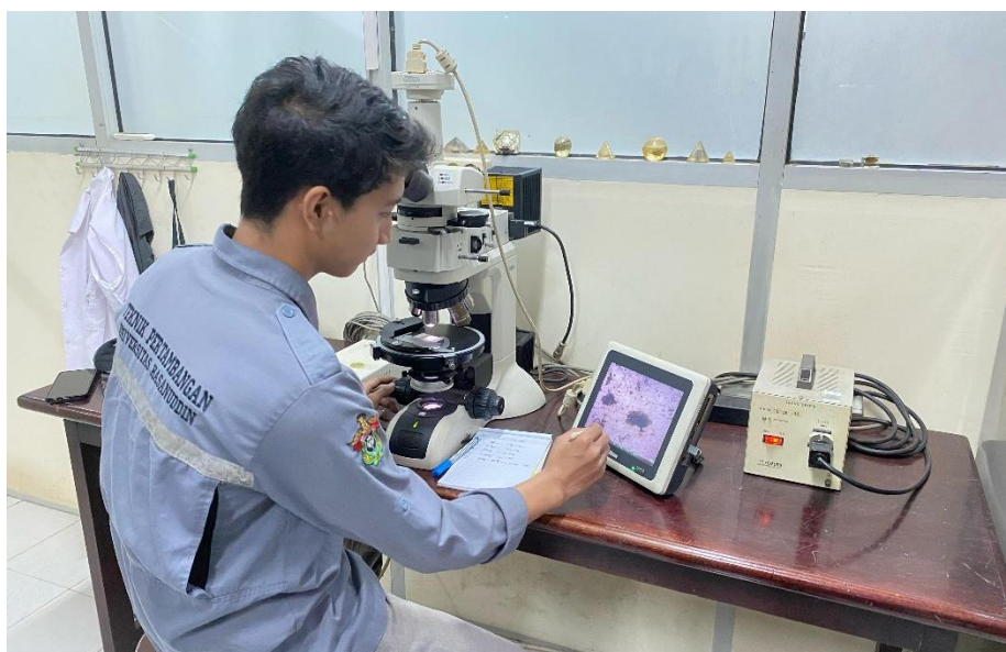
Gambar 6. Tahapan analisis menggunakan mikroskop Nikon Eclipse LV 100N POL
