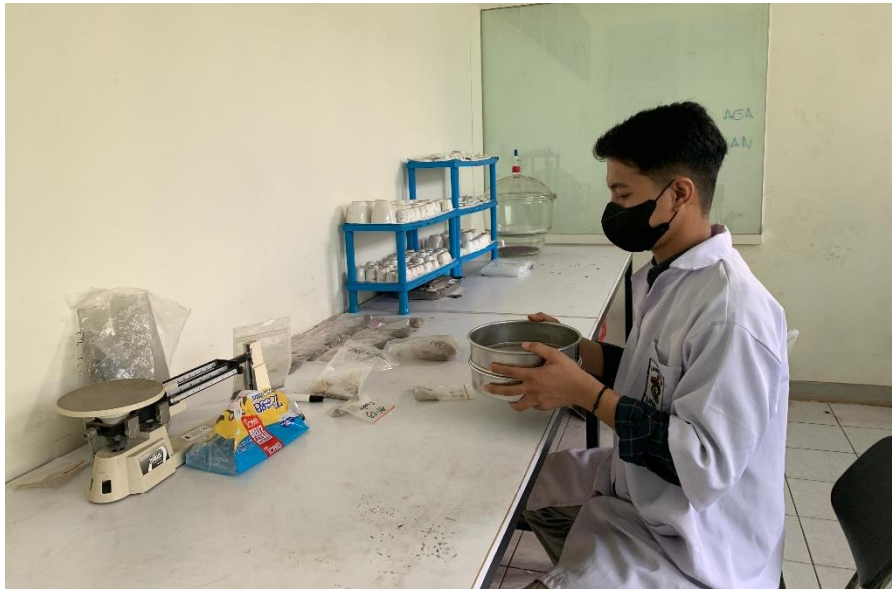
Gambar 4. Tahapan pengayakan sampel menggunakan ayakan 200 mesh
