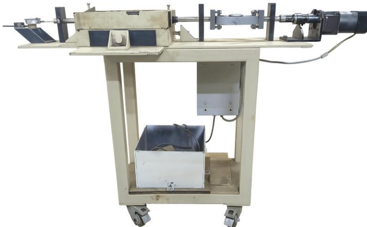
Gambar 24. Alat geser langsung yang telah di Modifikasi
