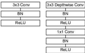
gambar 1 kiri: lapisan konvolusi standard dengan batchnorm dan relu . kanan: depthwise convolution dan pointwise convolution dengan batchnorm dan relu .
