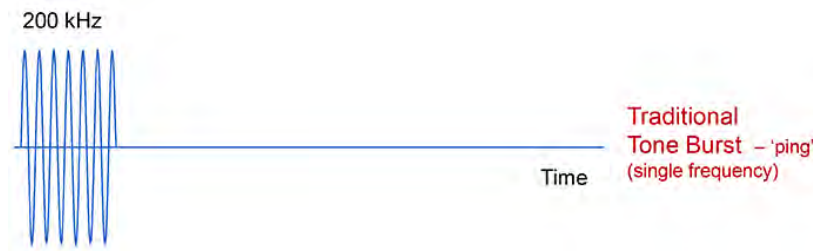
Gambar 3. Transmisi Frekuensi Sonar Singlebeam Echosounder
