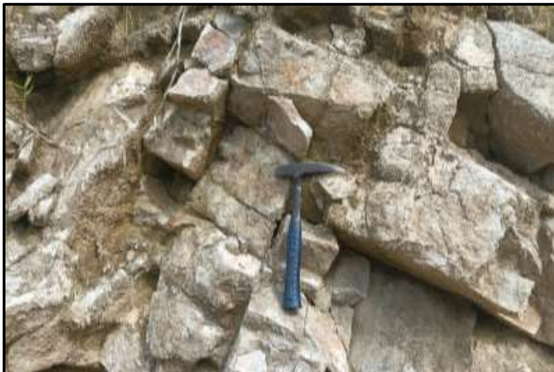
Gambar 6 Kenampakan pelapukan berupa rekahan akibat perubahan suhu dan tekanan pada Granit dengan arah foto N263°E pada stasiun 4
