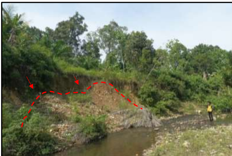
Gambar 17 Kenampakan pergerakan tanah berupa Debris Slide pada daerah Baebunta dengan arah foto N137°E
