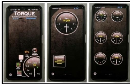
Gambar 18. Smartphone Android Yang Dilengkapi Dengan Aplikasi Torque Pro Sumber: Laboratorium Otomotif SMK Negeri 1 Maros
