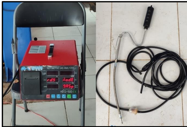
Gambar 16. Gas Analyzer KEG-500 dan Probe Sumber: Laboratorium Otomotif SMKN 1 Maros
