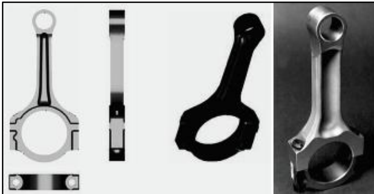
Gambar 6 Connecting rod dari AMC. Sumber: Stojanovic & Ivanovic (2015)
