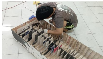
Gambar 31. Proses Pemasangan Gading
