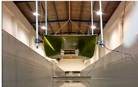
Gambar 46. Pemasangan model pada rel yang akan diuji Sumber: Prosedur pengujian model
