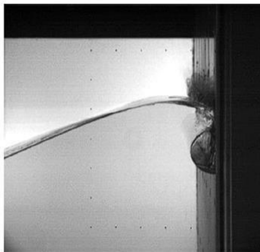
Gambar 11. Udara tertutup yang terbentuk akibat benturan datar dari gelombang yang pecah terhadap dinding vertikal
