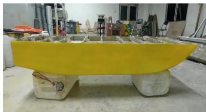
Gambar 37. Proses Pengecatan Model Kapal
