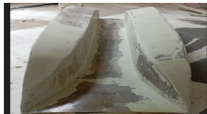
Gambar 36. Proses Pengaplikasian Dempul Pada Model Kapal
