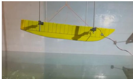
Gambar 47. Keadaan kapal pada posisi 0,3 meter di atas air Sumber: Prosedur pengujian model
