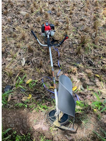
Gambar 1. Mesin Panen Padi Tipe Sandang ( Paddy Mower ).
