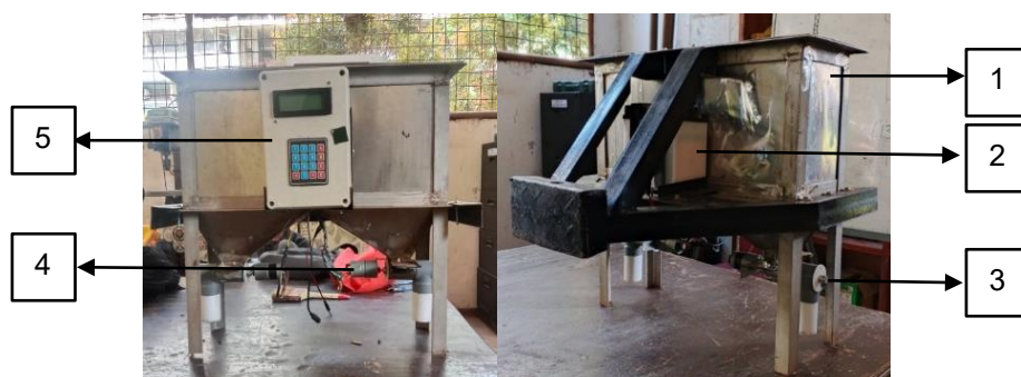
Gambar 1. Alat Pemupuk Granular Laju Variabel Tipe Auger .
