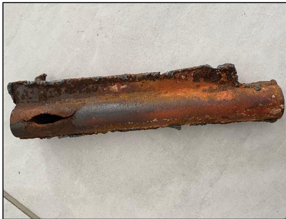
Gambar 3. Wingwall Tube Setelah 11 Tahun Pengoperasian
