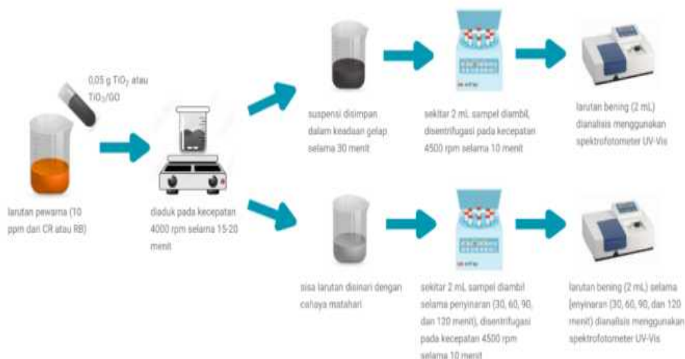
Gambar II.3 Uji aktivitas fotokatalitik \text{TiO}_2 dan nanokomposit \text{TiO}_2/\text{Graphene Oxide} terhadap zat pewarna Congo Red dan Rhodamine B
