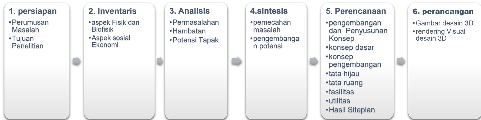
Gambar 2. Bagan Proses Perancangan Lanskap dengan Metode Gold (1980)
