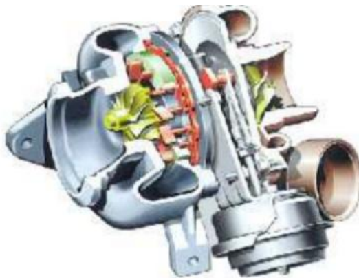
Gambar 3. Turbocharger dengan variabel geometri turbo
