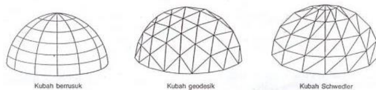
Gambar 4. Bentuk kubah B (Sumber : schodek, structure, 1999 hal. 451)
