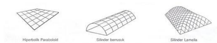
Gambar 5. Bentuk Kubah C (Sumber: schodek, structure, 1999 hal. 451)
