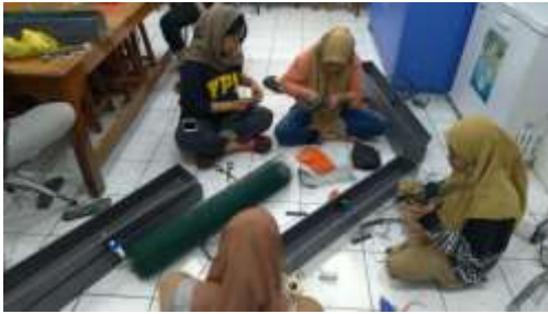
Proses pengeleman waring pada talang air
