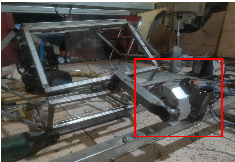
Gambar 4.2 Poros Putar Motor Penggerak (Kotak Merah)
