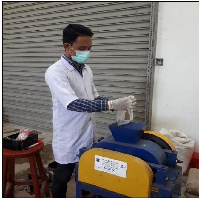
Gambar 3.5. Proses peremukkan menggunakan double roll crusher untuk memperoleh ukuran butir yang lebih halus.
