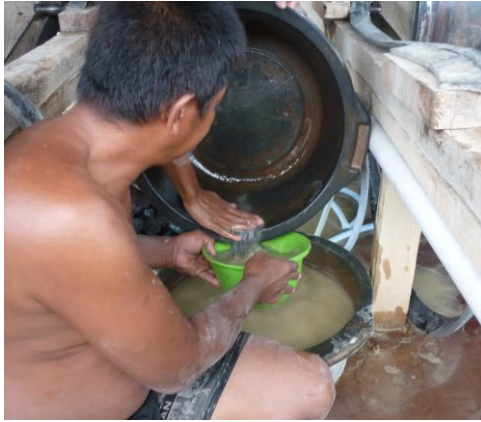
Foto Proses Amalgamasi di Kelurahan Kawatuna
