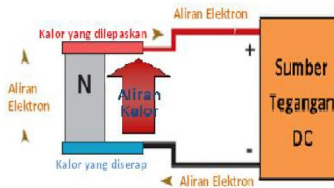
Gambar 5. Arah aliran elektron pada semikonduktor tipe N (Tellurex. 2010)
