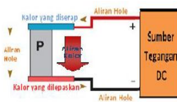
Gambar 6. Arah aliran hole pada semikonduktor tipe P (Tellurex. 2010)
