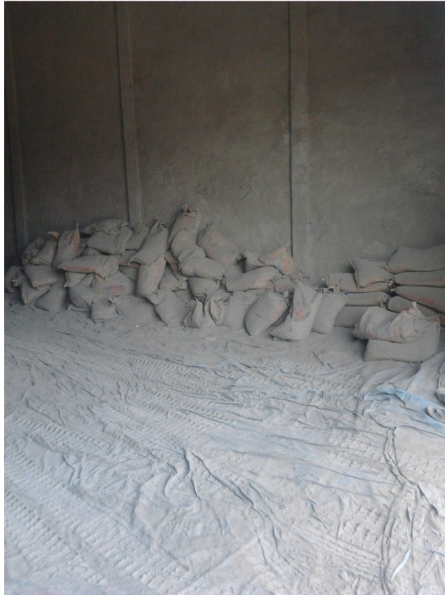
Tumpukan semen yang belum ditata rapi tepat di depan pintu masuk gudang
