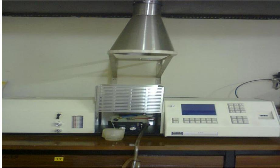
**Gambar 4.** Spektrofotometer Serapan Atom (SSA)
