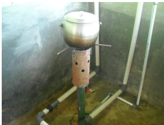
Gambar 2. Instalasi pemurnian Gas Metan
