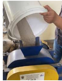
Proses Penghalusan Pecahan Terumbu Karang Jahe
