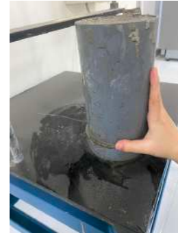
Pemadatan Beton Segar Dengan Cara Digetarkan dan Ditusuk Dengan Tongkat Pematat
