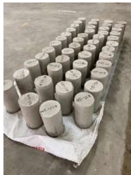
Beton Segar yang Sudah Dicor Didiamkan Kurang Lebih 32 Jam
