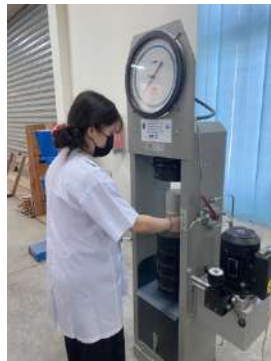
Pengujian Beton pada Hari ke-7, 14, 21, dan 28
