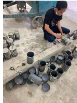
Pemadatan Beton Segar Dengan Cara Digetarkan dan Ditusuk Dengan Tongkat Pematat
