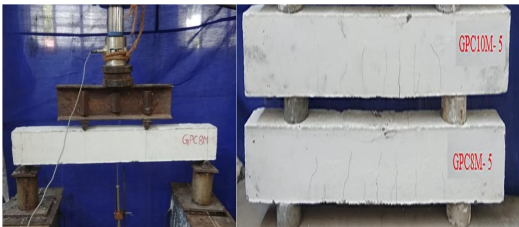
Gambar 2. Pengujian lentur dan pola retak pada balok
