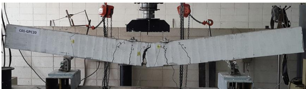
Gambar 4. Pengujian lentur balok beton geopolimer
