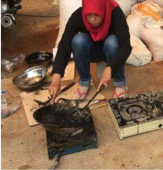
Proses Pemanasan Agregat dan Aspal Minyak
