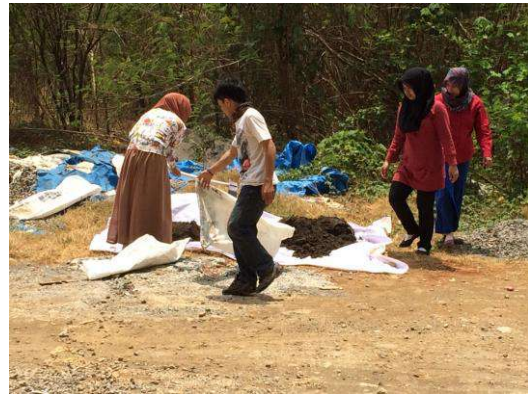
Proses pengeringan agregat
