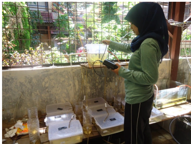
Lampiran 29. Pengukuran konsumsi oksigen hewan uji dengan menggunakan DO meter.
