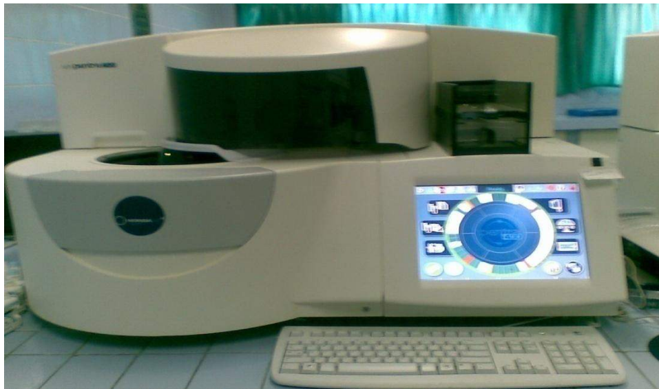
Ket: Alat otomatis ABX Pentra 400 untuk pemeriksaan elektrolit
