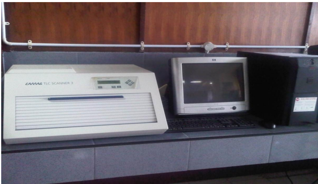
Gambar 7. Alat densitometer dengan perangkat yang mengontrol kerja dari TLC scanner
