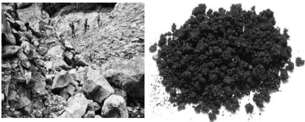
Gambar 3. Asbuton bongkahan dan LGA
