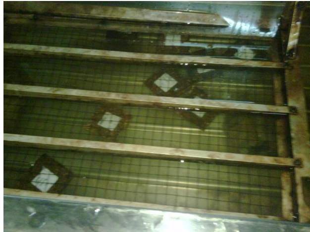
Perendaman untuk pengujian Pengembangan Tebal dan DSA
