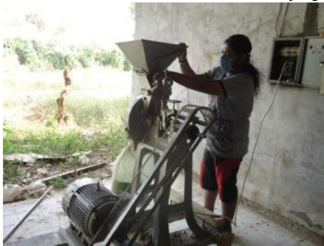
Penggilingan tatal bambu untuk mendapatkan hasil berbentuk partikel
