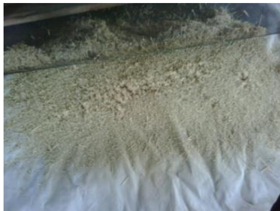
Hasil penyaringan partikel lolos 10 mesh
