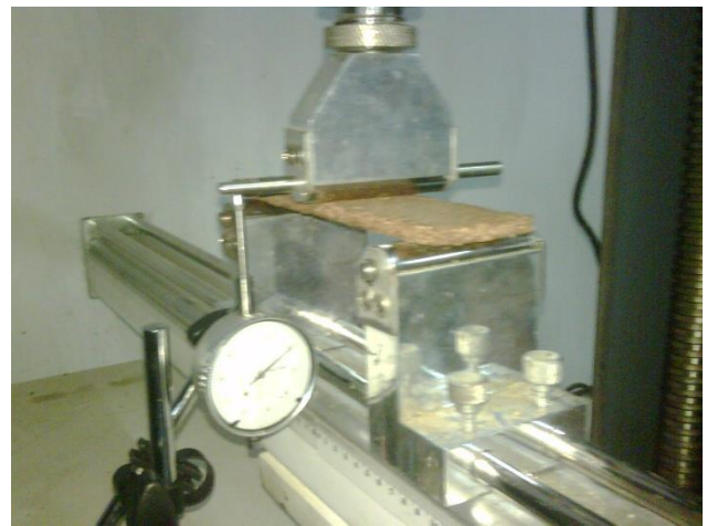
Perendaman untuk pengujian Pengembangan Tebal dan DSA
