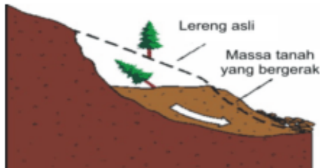
Gambar 2-2. Longsor Rotasi (Peraturan Menteri Pekerjaan Umum No.22/Prt/M/2007)
