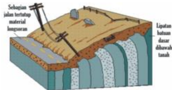
Gambar 2-5. Longsor Rayapan Tanah (Peraturan Menteri Pekerjaan Umum No.22/Prt/M/2007)
