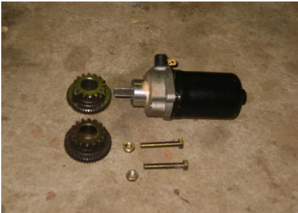
Gigi Transmisi, Actuator dan Baut Roda Robot Penjinak Bom
