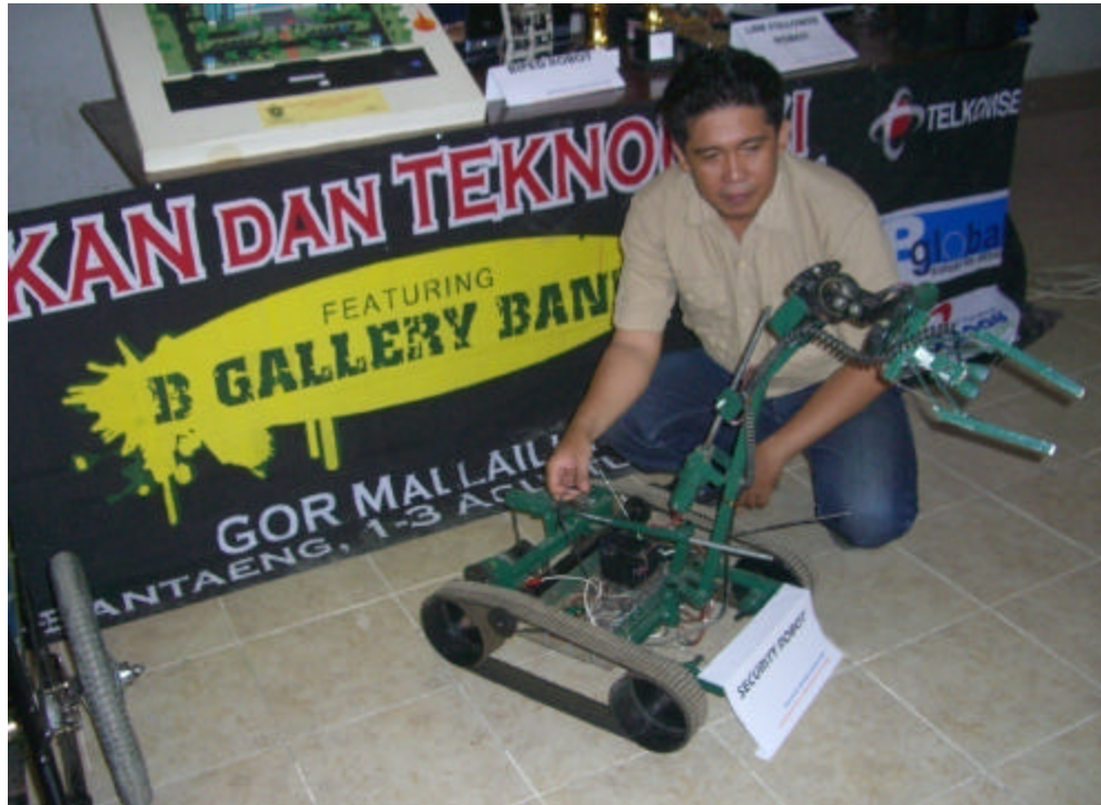
Robot Penjinak Bom diikuti sertakan dalam Pameran Teknologi di Kabupaten Bantaeng pada Agustus 2008
