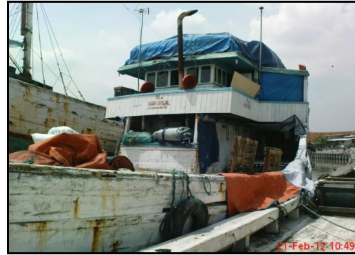
Gambar 14. Pemadatan muatan sampai geladak navigasi
