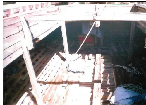
Gambar 12. Ruang muat kapal pinisi tanpa sekat tubrukan
