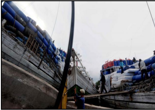
Gambar 13. Pemadatan muatan sampai ke geladak cuaca
