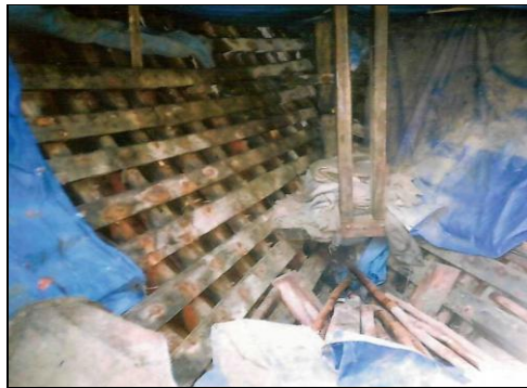
Gambar 11. Ruang muat kapal pinisi tanpa sekat tubrukan
