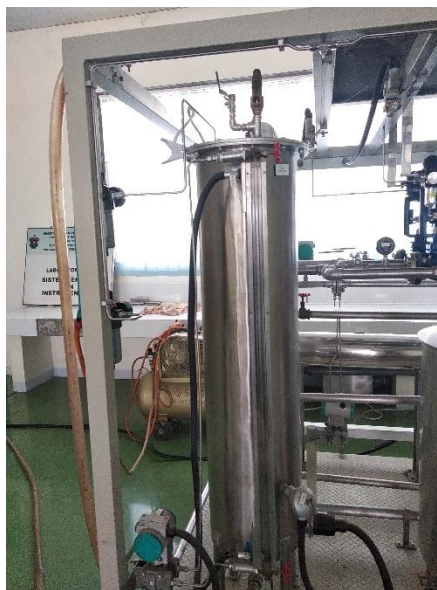
Gambar 2.2 Boiler pada Alat Boiler heating batching control trainer ( Model : Se 107)
