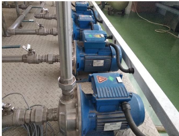
Gambar 2.21 Pompa pada Alat Boiler heating batching control trainer ( Model : Se 107)
